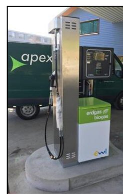
Gilbarco Zapfsäule Typ SK 700 temperaturkompensiert
