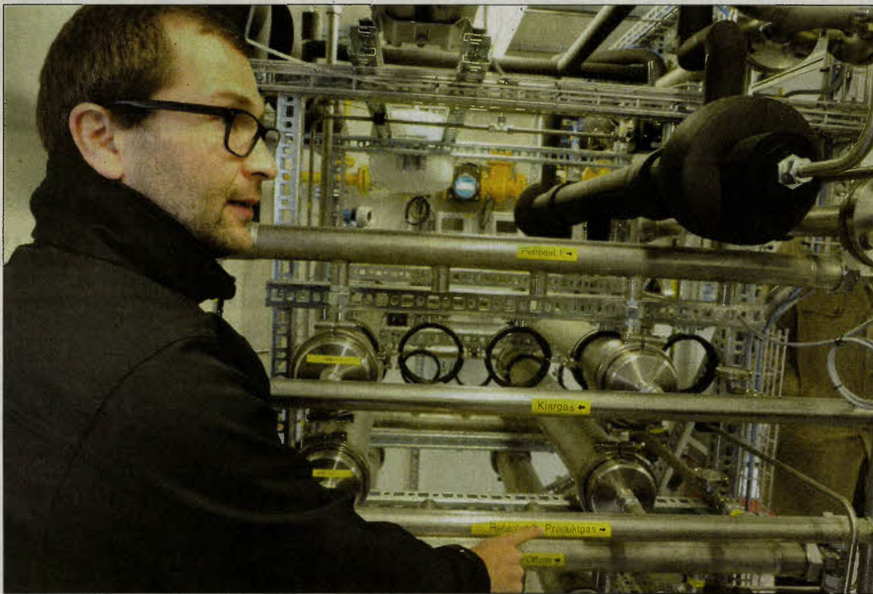
Hunderte von Leitungen für einen eigentlich simplen Prozess: Projektleiter Christian Müller erklärt, wie gute CH 4 - und schlechte CO 2 -Moleküle in den Membranen voneinander getrennt und anschliessend weiterverarbeitet werden. (Bilder: rc.)
