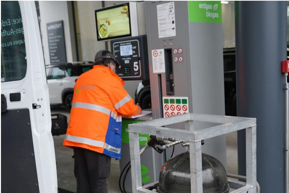
Apex-Mitarbeiter Fischbacher rechnet die Abweichung aus und bereitet die Messprotokolle vor. Quelle: CNG-Mobility.ch
