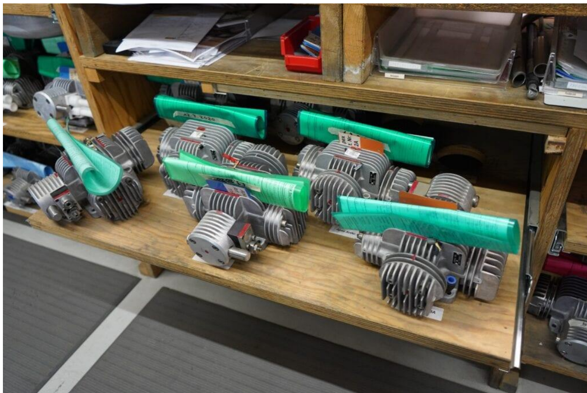
Totalrevidiert und wieder zum Einsatz bereit: Kompressoren für CNG-/Biogas-Tankstellen. Quelle: CNG-Mobility.ch
