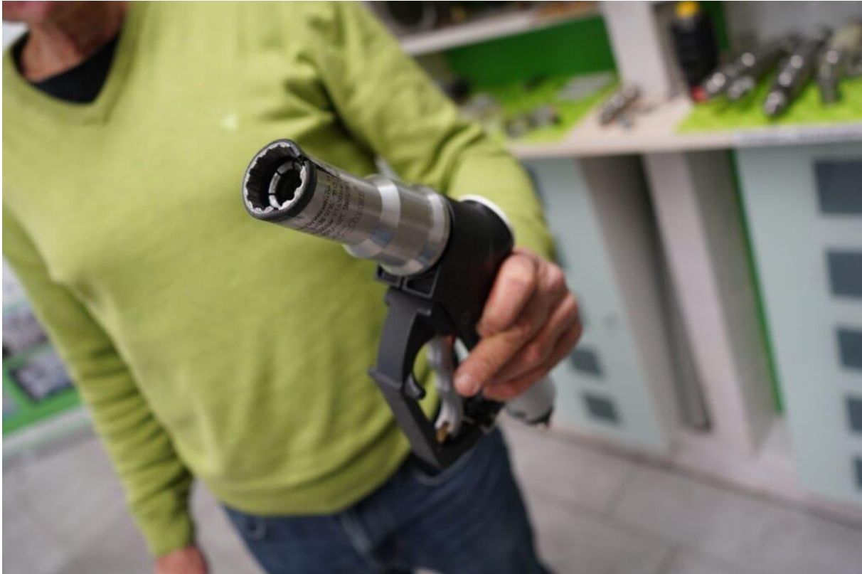
Buse de remplissage défectueuse provenant de la collection d'objets de démonstration d'Apex AG. Source : CNG-Mobility.ch
