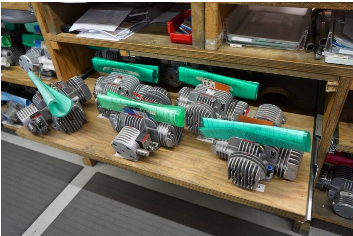
Entièrement révisés et à nouveau prêts à l’emploi : compresseurs pour les stations de remplissage de GNC/biogaz. Source : CNG-Mobility.ch
